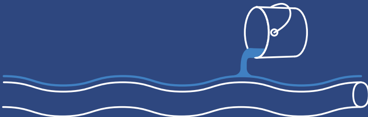
Fig.2 - En flexibel strømpeforing mettes med epoxy
